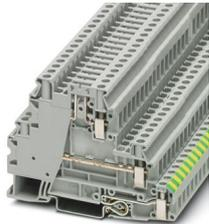
Morsetto a più piani, Corrente e tensione sono determinate dalla spina impiegata., tensione nominale: 500 V, corrente nominale: 28 A, tipo di connessione: Connessione a vite, Sezione di dimensionamento: 4 mm<sup>2</sup>, sezione: 0,14 mm<sup>2</sup> - 6 mm<sup>2</sup>, tipo di connessione: Connessione a vite, Sezione di dimensionamento: 2,5 mm<sup>2</sup>, sezione: 0,14 mm<sup>2</sup> - 6 mm<sup>2</sup>, montaggio: NS 35/7,5, NS 35/15, colore: grigio
