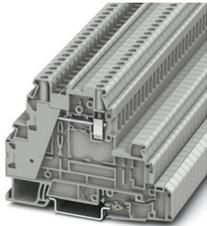
Morsetto a più piani, tensione nominale: 500 V, corrente nominale: 32 A, numero di connessioni: 2, tipo di connessione: Connessione a vite, Sezione di dimensionamento: 4 mm<sup>2</sup>, sezione: 0,14 mm<sup>2</sup> - 6 mm<sup>2</sup>, Connessione a vite, Sezione di dimensionamento: 4 mm<sup>2</sup>, sezione: 0,14 mm<sup>2</sup> - 6 mm<sup>2</sup>, tipo di montaggio: NS 35/7,5, NS 35/15, colore: grigio
