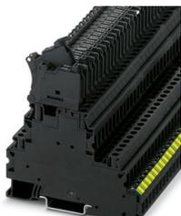
Morsetto portafusibili, tipo di fusibile: Vetro / ceramica / ..., tipo fusibile: G / 5 x 20, tensione nominale: 60 V, Corrente continua termica  $I_{th}$ : 30 A, tipo di connessione: Connessione a vite, Sezione di dimensionamento: 4 mm<sup>2</sup>, sezione: 0,14 mm<sup>2</sup>- 6 mm<sup>2</sup>, tipo di connessione: Connessione a vite, Sezione di dimensionamento: 4 mm<sup>2</sup>, sezione: 0,14 mm<sup>2</sup>- 6 mm<sup>2</sup>, tipo di montaggio: NS 35/7,5, NS 35/15, colore: nero
