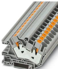
Morsetto per installazioni, tensione nominale: 500 V, corrente nominale: 76 A, Connessione Push-in, 1. piano, Sezione di dimensionamento: 16 mm<sup>2</sup>, sezione: 0,5 mm<sup>2</sup> - 16 mm<sup>2</sup>, tipo di montaggio: NS 35/7,5, NS 35/15, colore: grigio
