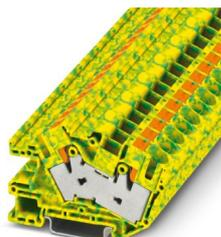
Morsetto per conduttore di terra per installazione, tensione nominale: 500 V, corrente nominale: 76 A, Connessione Push-in, 1. piano, Sezione di dimensionamento: 16 mm<sup>2</sup>, sezione: 0,5 mm<sup>2</sup> - 16 mm<sup>2</sup>, tipo di montaggio: NS 35/7,5, NS 35/15, colore: giallo-verde
