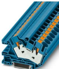
Morsetto per installazioni, tensione nominale: 500 V, corrente nominale: 76 A, Connessione Push-in, 1. piano, Sezione di dimensionamento: 16 mm<sup>2</sup>, sezione: 0,5 mm<sup>2</sup> - 16 mm<sup>2</sup>, tipo di montaggio: NS 35/7,5, NS 35/15, colore: blu
