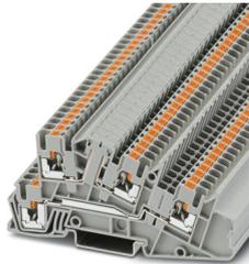
Morsetto di installazione a più piani, con connettore passante integrato, tensione nominale: 400 V, corrente nominale: 24 A, Connessione Push-in, 1. e 2. piano, Sezione di dimensionamento: 2,5 mm<sup>2</sup>, sezione: 0,14 mm<sup>2</sup> - 4 mm<sup>2</sup>, Connessione Push-in, Sezione di dimensionamento: 1,5 mm<sup>2</sup>, tipo di montaggio: NS 35/7,5, NS 35/15, colore: grigio
