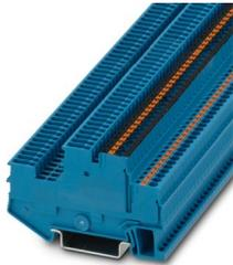
Morsetto passante a due piani, Corrente e tensione sono determinate dalla spina impiegata., con ripartitore di potenziale, tensione nominale: 500 V, corrente nominale: 16 A, tipo di connessione: Push-in / attacco connettore, 1. e 2. piano, Sezione di dimensionamento: 1,5 mm<sup>2</sup>, sezione: 0,14 mm<sup>2</sup> - 1,5 mm<sup>2</sup>, tipo di montaggio: NS 35/7,5, NS 35/15, colore: blu
