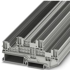
Morsetto passante a due piani, Corrente e tensione sono determinate dalla spina impiegata., con ripartitore di potenziale, tensione nominale: 500 V, corrente nominale: 16 A, tipo di connessione: Attacco connettore, 1. e 2. piano, Sezione di dimensionamento: 1,5 mm<sup>2</sup>, sezione: 0,14 mm<sup>2</sup> - 1,5 mm<sup>2</sup>, tipo di montaggio: NS 35/7,5, NS 35/15, colore: grigio
