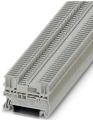
Morsetto passante, tensione nominale: 500 V, corrente nominale: 17,5 A, numero di connessioni: 2, tipo di connessione: Attacco connettore, Sezione di dimensionamento: 1,5 mm<sup>2</sup>, 1. piano, sezione: 0,14 mm<sup>2</sup> - 1,5 mm<sup>2</sup>, tipo di montaggio: NS 35/7,5, NS 35/15, colore: grigio
