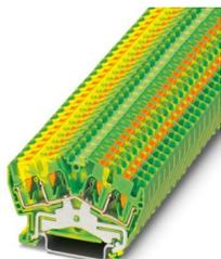
Morsetti comp. per conduttori terra, numero di connessioni: 4, tipo di connessione: Connessione Push-in, 1. piano, sezione:  $0,2 \text{ mm}^2 - 6 \text{ mm}^2$ , tipo di montaggio: NS 35/7,5, NS 35/15, colore: giallo-verde
