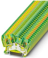
Morsetti comp. per conduttori terra, numero di connessioni: 3, tipo di connessione: Connessione Push-in, 1. piano, sezione:  $0,2 \text{ mm}^2 - 6 \text{ mm}^2$ , tipo di montaggio: NS 35/7,5, NS 35/15, colore: giallo-verde
