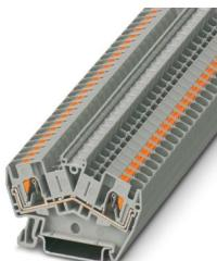
Morsetto passante, tensione nominale: 800 V, corrente nominale: 32 A, numero di connessioni: 2, tipo di connessione: Connessione Push-in, Sezione di dimensionamento: 4 mm<sup>2</sup>, 1. piano, sezione: 0,2 mm<sup>2</sup> - 6 mm<sup>2</sup>, tipo di montaggio: NS 35/7,5, NS 35/15, colore: grigio
