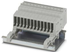
Giunto COMBI, tensione nominale: 500 V, corrente nominale: 17,5 A, numero di connessioni: 1, numero poli: 12, tipo di connessione: Connessione Push-in, Sezione di dimensionamento: 1,5 mm<sup>2</sup>, 1. piano, sezione: 0,14 mm<sup>2</sup> - 1,5 mm<sup>2</sup>, tipo di montaggio: NS 35/15, NS 35/7,5, colore: grigio
