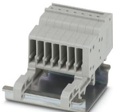
Giunto COMBI, tensione nominale: 500 V, corrente nominale: 17,5 A, numero di connessioni: 1, numero poli: 7, tipo di connessione: Connessione Push-in, Sezione di dimensionamento: 1,5 mm<sup>2</sup>, 1. piano, sezione: 0,14 mm<sup>2</sup> - 1,5 mm<sup>2</sup>, colore: grigio
