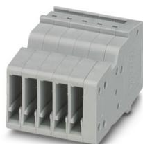
Giunto COMBI, tensione nominale: 500 V, corrente nominale: 17,5 A, numero di connessioni: 1, numero poli: 5, tipo di connessione: Connessione Push-in, Sezione di dimensionamento: 1,5 mm<sup>2</sup>, 1. piano, sezione: 0,14 mm<sup>2</sup> - 1,5 mm<sup>2</sup>, colore: grigio
