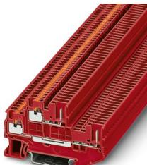
Morsetto passante a due piani, Corrente e tensione sono determinate dalla spina impiegata., tensione nominale: 500 V, corrente nominale: 16 A, tipo di connessione: Push-in / attacco connettore, 1. e 2. piano, Sezione di dimensionamento: 1,5 mm<sup>2</sup>, sezione: 0,14 mm<sup>2</sup> - 1,5 mm<sup>2</sup>, tipo di montaggio: NS 35/7,5, NS 35/15, colore: rosso
