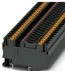
Morsetto portafusibili, tipo di fusibile: Piatta, tipo fusibile: Tipo C / max. 2,2 W, tensione nominale: 48 V, corrente nominale: 25 A, tipo di connessione: Connessione Push-in, Sezione di dimensionamento: 6 mm<sup>2</sup>, sezione: 0,5 mm<sup>2</sup>- 10 mm<sup>2</sup>, tipo di montaggio: NS 35/7,5, NS 35/15, colore: nero
