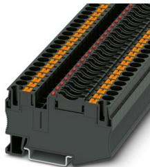
Morsetto portafusibili, tipo di fusibile: Piatta, tipo fusibile: Tipo C / max.2,2 W, tensione nominale: 12 V, corrente nominale: 25 A, tipo di connessione: Connessione Push-in, Sezione di dimensionamento: 6 mm<sup>2</sup>, sezione: 0,5 mm<sup>2</sup>- 10 mm<sup>2</sup>, tipo di montaggio: NS 35/7,5, NS 35/15, colore: nero
