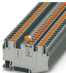
Morsetto con sezionatore a coltello, tensione nominale: 500 V, corrente nominale: 20 A, tipo di connessione: Connessione Push-in, Sezione di dimensionamento: 6 mm<sup>2</sup>, sezione: 0,5 mm<sup>2</sup> - 10 mm<sup>2</sup>, montaggio: NS 35/7,5, NS 35/15, colore: grigio
