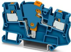
Morsetto sezionatore per conv. misura, tensione nominale: 500 V, corrente nominale: 24 A, numero di connessioni: 2, tipo di connessione: Connessione Push-in, Sezione di dimensionamento: 4 mm<sup>2</sup>, 1. piano, sezione: 0,2 mm<sup>2</sup> - 6 mm<sup>2</sup>, tipo di montaggio: NS 35/7,5, NS 35/15, colore: blu
