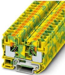
Morsetti comp. per conduttori terra, numero di connessioni: 2, tipo di connessione: Connessione Push-in, Sezione di dimensionamento: 10 mm<sup>2</sup>, sezione: 0,5 mm<sup>2</sup> - 16 mm<sup>2</sup>, tipo di montaggio: NS 35/7,5, NS 35/15, colore: giallo-verde
