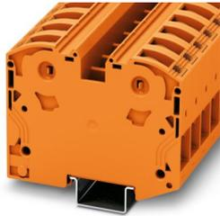
Morsetti di potenza, tensione nominale: 1000 V, corrente nominale: 125 A, numero di connessioni: 2, numero poli: 1, tipo di connessione: Connessione PowerTurn, Sezione di dimensionamento: 35 mm<sup>2</sup>, sezione: 2,5 mm<sup>2</sup> - 35 mm<sup>2</sup>, tipo di montaggio: NS 35/15, colore: arancione
