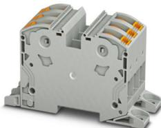
Morsetti di potenza, bloccato, tensione nominale: 1000 V, corrente nominale: 125 A, numero di connessioni: 6, numero poli: 3, tipo di connessione: Connessione PowerTurn, Sezione di dimensionamento: 35 mm<sup>2</sup>, sezione: 2,5 mm<sup>2</sup> - 35 mm<sup>2</sup>, tipo di montaggio: avvitamento diretto, colore: grigio
