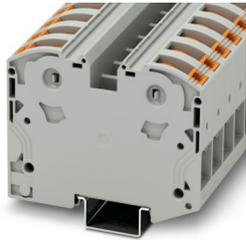
Morsetti di potenza, tensione nominale: 1000 V, corrente nominale: 125 A, numero di connessioni: 2, tipo di connessione: Connessione PowerTurn, Sezione di dimensionamento: 35 mm<sup>2</sup>, sezione: 2,5 mm<sup>2</sup> - 35 mm<sup>2</sup>, tipo di montaggio: NS 35/15, colore: grigio
