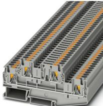
Morsetto sezionatore, Corrente e tensione sono determinate dalla spina impiegata., tensione nominale: 500 V, corrente nominale: 28 A, 1. piano, tipo di connessione: Connessione Push-in, Sezione di dimensionamento: 4 mm<sup>2</sup>, sezione: 0,2 mm<sup>2</sup> - 6 mm<sup>2</sup>, 2. piano, tipo di connessione: Connessione Push-in, Sezione di dimensionamento: 4 mm<sup>2</sup>, sezione: 0,2 mm<sup>2</sup> - 6 mm<sup>2</sup>, montaggio: NS 35/7,5, NS 35/15, colore: blu
