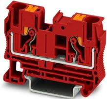
Morsetto passante, tensione nominale: 1000 V, corrente nominale: 41 A, numero di connessioni: 2, tipo di connessione: Connessione Push-in, Sezione di dimensionamento: 6 mm<sup>2</sup>, sezione: 0,5 mm<sup>2</sup> - 10 mm<sup>2</sup>, tipo di montaggio: NS 35/7,5, NS 35/15, colore: rosso
