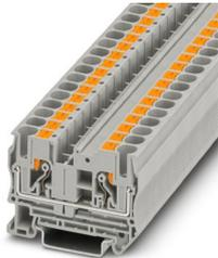
Morsetto passante, tensione nominale: 1000 V, corrente nominale: 41 A, numero di connessioni: 2, numero poli: 1, tipo di connessione: Connessione Push-in, Sezione di dimensionamento: 6 mm<sup>2</sup>, sezione: 0,5 mm<sup>2</sup> - 10 mm<sup>2</sup>, tipo di montaggio: NS 35/7,5, NS 35/15, colore: grigio
