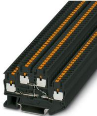
Componente morsetto componibile, con diodo integrato 1N4007, corrente nominale: 0,5 A, numero di connessioni: 4, tipo di connessione: Connessione Push-in, Sezione di dimensionamento: 2,5 mm<sup>2</sup>, 1. e 2. piano, sezione: 0,14 mm<sup>2</sup> - 4 mm<sup>2</sup>, tipo di montaggio: NS 35/7,5, NS 35/15, colore: nero
