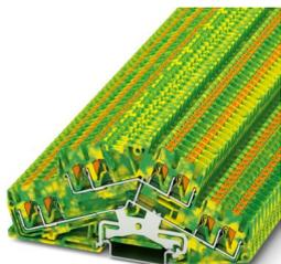
Morsetto passante a due piani, numero di connessioni: 8, tipo di connessione: Connessione Push-in, 1. e 2. piano, Sezione di dimensionamento: 2,5 mm<sup>2</sup>, sezione: 0,14 mm<sup>2</sup> - 4 mm<sup>2</sup>, tipo di montaggio: NS 35/7,5, NS 35/15, colore: giallo-verde
