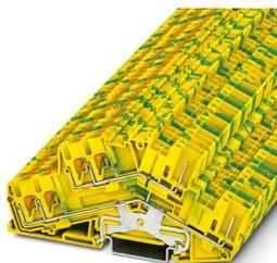
Morsetto a due piani per conduttori di terra, numero di connessioni: 6, tipo di connessione: Push-in / attacco connettore, 1. e 2. piano, Sezione di dimensionamento: 2,5 mm<sup>2</sup>, sezione: 0,14 mm<sup>2</sup> - 4 mm<sup>2</sup>, tipo di montaggio: NS 35/7,5, NS 35/15, colore: giallo-verde
