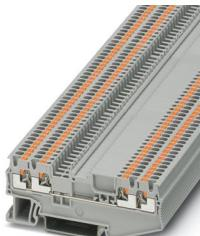
Morsetto passante, dal profilo identico al morsetto sezionatore con leva, tensione nominale: 400 V, corrente nominale: 17,5 A, numero di connessioni: 4, tipo di connessione: Connessione Push-in, Sezione di dimensionamento: 1,5 mm<sup>2</sup>, 1. piano, sezione: 0,14 mm<sup>2</sup> - 1,5 mm<sup>2</sup>, tipo di montaggio: NS 35/7,5, NS 35/15, colore: grigio
