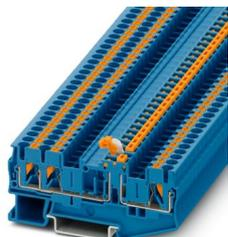
Morsetto con sezionatore a coltello, tensione nominale: 400 V, corrente nominale: 16 A, tipo di connessione: Connessione Push-in, Sezione di dimensionamento: 2,5 mm<sup>2</sup>, sezione: 0,14 mm<sup>2</sup> - 4 mm<sup>2</sup>, montaggio: NS 35/7,5, NS 35/15, colore: blu
