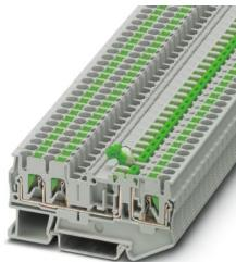
Morsetto con sezionatore a coltello, con sezionatore a coltello verde e pulsanti di azionamento verdi, tensione nominale: 400 V, corrente nominale: 20 A, tipo di connessione: Connessione Push-in, Sezione di dimensionamento: 2,5 mm<sup>2</sup>, sezione: 0,14 mm<sup>2</sup> - 4 mm<sup>2</sup>, montaggio: NS 35/7,5, NS 35/15, colore: grigio
