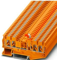
Morsetto con sezionatore a coltello, tensione nominale: 400 V, corrente nominale: 20 A, tipo di connessione: Connessione Push-in, Sezione di dimensionamento: 2,5 mm<sup>2</sup>, sezione: 0,14 mm<sup>2</sup> - 4 mm<sup>2</sup>, montaggio: NS 35/7,5, NS 35/15, colore: arancione
