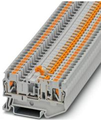
Morsetto con sezionatore a coltello, tensione nominale: 400 V, corrente nominale: 20 A, tipo di connessione: Connessione Push-in, Sezione di dimensionamento: 2,5 mm<sup>2</sup>, sezione: 0,14 mm<sup>2</sup> - 4 mm<sup>2</sup>, montaggio: NS 35/7,5, NS 35/15, colore: grigio
