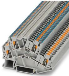
Morsetto a due piani, tensione nominale: 500 V, corrente nominale: 22 A, tipo di connessione: Connessione Push-in, 1. e 2. piano, Sezione di dimensionamento: 2,5 mm<sup>2</sup>, sezione: 0,14 mm<sup>2</sup> - 4 mm<sup>2</sup>, tipo di montaggio: NS 35/7,5, NS 35/15, colore: grigio
