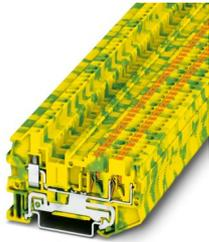
Morsetti comp. per conduttori terra, tensione nominale: 800 V, tipo di connessione: Connessione Push-in, sezione: 0,14 mm<sup>2</sup> - 4 mm<sup>2</sup>, tipo di connessione: Connessione a vite, Sezione di dimensionamento: 2,5 mm<sup>2</sup>, sezione: 0,14 mm<sup>2</sup> - 4 mm<sup>2</sup>, montaggio: NS 35/7,5, NS 35/15, colore: giallo-verde
