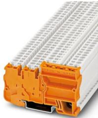
Morsetto di alimentazione, tensione nominale: 250 V, corrente nominale: 30 A, numero di connessioni: 2, tipo di connessione: Connessione a molla, Sezione di dimensionamento: 2,5 mm<sup>2</sup>, sezione: 0,08 mm<sup>2</sup> - 4 mm<sup>2</sup>, tipo di montaggio: NS 35/7,5, NS 35/15, colore: arancione
