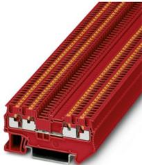
Morsetto passante, tensione nominale: 500 V, corrente nominale: 17,5 A, numero di connessioni: 4, tipo di connessione: Connessione Push-in, Sezione di dimensionamento: 1,5 mm<sup>2</sup>, 1. piano, sezione: 0,14 mm<sup>2</sup> - 1,5 mm<sup>2</sup>, tipo di montaggio: NS 35/7,5, NS 35/15, colore: rosso
