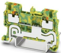
Morsetti comp. per conduttori terra, numero di connessioni: 2, tipo di connessione: Connessione Push-in, 1. piano, sezione: 0,14 mm<sup>2</sup> - 1,5 mm<sup>2</sup>, tipo di montaggio: NS 35/7,5, NS 35/15, colore: giallo-verde
