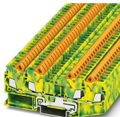
Morsetti comp. per conduttori terra, numero di connessioni: 4, tipo di connessione: Connessione rapida, sezione: 0,5 mm<sup>2</sup> - 2,5 mm<sup>2</sup>, tipo di montaggio: NS 35/7,5, NS 35/7,5, colore: giallo-verde
