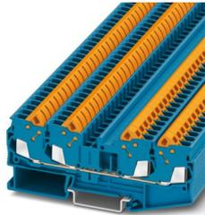
Morsetto passante, tensione nominale: 800 V, corrente nominale: 24 A, numero di connessioni: 4, tipo di connessione: Connessione rapida, Sezione di dimensionamento: 2,5 mm<sup>2</sup>, 1. piano, sezione: 0,5 mm<sup>2</sup> - 2,5 mm<sup>2</sup>, tipo di montaggio: NS 35/7,5, NS 35/7,5, colore: blu
