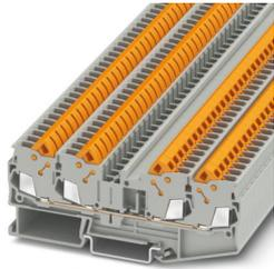
Morsetto passante, tensione nominale: 800 V, corrente nominale: 24 A, numero di connessioni: 4, tipo di connessione: Connessione rapida, Sezione di dimensionamento: 2,5 mm<sup>2</sup>, 1. piano, sezione: 0,5 mm<sup>2</sup> - 2,5 mm<sup>2</sup>, tipo di montaggio: NS 35/7,5, NS 35/7,5, colore: grigio
