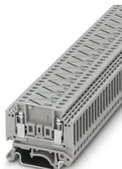
Coppia di morsetti per termocoppie, TC tipo B, tensione nominale: 400 V, corrente nominale: 1 A, numero di connessioni: 4, numero poli: 2, tipo di connessione: Connessione a vite, sezione: 0,2 mm<sup>2</sup> - 4 mm<sup>2</sup>, tipo di montaggio: NS 35/7,5, NS 35/15, NS 32, colore: grigio
