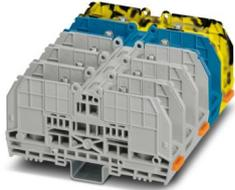
Morsetto di collegamento a bullone, tensione nominale: 1000 V, corrente nominale: 192 A, numero di connessioni: 10, numero poli: 5, tipo di connessione: Bullone, Sezione di dimensionamento: 70 mm<sup>2</sup>, 1. piano, tipo di montaggio: NS 35/7,5, NS 35/15, avvitamento diretto, colore: grigio/blu/nero-giallo
