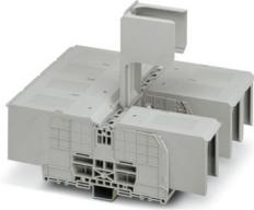
Morsetto di collegamento a bullone, tensione nominale: 1500 V, corrente nominale: 415 A, numero di connessioni: 8, tipo di connessione: Bullone, Sezione di dimensionamento: 240 mm<sup>2</sup>, tipo di montaggio: NS 35/7,5, NS 35/15, avvitamento diretto, colore: grigio
