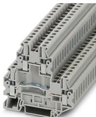
Componente morsetto componibile, per il montaggio di componenti selezionabili a piacere, tensione nominale: 800 V, corrente nominale: 30 A, tipo di connessione: Connessione a vite, Sezione di dimensionamento: 4 mm<sup>2</sup>, sezione: 0,14 mm<sup>2</sup> - 6 mm<sup>2</sup>, tipo di montaggio: NS 35/7,5, NS 35/15, colore: grigio
