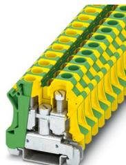
Morsetto per conduttore di terra per installazione, numero di connessioni: 2, numero poli: 1, tipo di connessione: Connessione a vite, 1. piano, collegamento a destra, Sezione di dimensionamento: 16 mm<sup>2</sup>, sezione: 6 mm<sup>2</sup> - 25 mm<sup>2</sup>, tipo di fissaggio: Piedino PE con vite di fissaggio M4, tipo di montaggio: NS 35/7,5, NS 35/15, colore: giallo-verde
