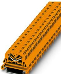
Minimorsetto passante, tensione nominale: 800 V, corrente nominale: 24 A, numero di connessioni: 4, tipo di connessione: Connessione a molla, Sezione di dimensionamento: 2,5 mm<sup>2</sup>, 1. piano, sezione: 0,08 mm<sup>2</sup> - 4 mm<sup>2</sup>, tipo di montaggio: NS 35/7,5, NS 35/15, colore: arancione
